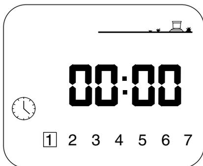
Drücken Sie wiederholt die Taste  $\rightarrow$ , bis Sie diese Anzeige sehen. Mit den Tasten +/ON und -/OFF können Sie die Uhr einstellen.
