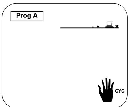
Ein Zyklus besteht aus dem nacheinanderfolgenden Betrieb aller Stationen, die dem selben Programm zugeordnet sind. Drücken Sie wiederholt die Taste  $\rightarrow$  bis Sie diese Anzeige sehen. Wählen Sie mit der Taste ABC das gewünschte Programm A, B oder C, in dem Sie den Zyklus starten möchten.
