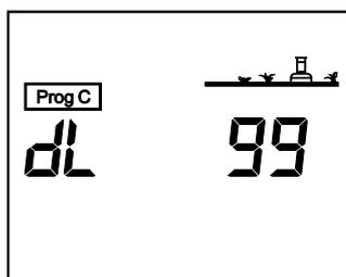
Drücken Sie wiederholt die Taste  $\rightarrow$ , bis Sie diese Anzeige sehen. Stellen Sie mit der ABC Taste das Programm ein, für das Sie eine Verzögerung zwischen allen Stationen einstellen möchten. Stellen Sie die Verzögerung in 1-Sek. Schritten von 0 bis 99 Sekunden mit +/ON oder -/ÖFF ein. Die Standardeinstellung ist 0, d. h. es gibt keine Verzögerungsphase zwischen den Stationen. Die max. Einstellung ist 99 Sekunden.
