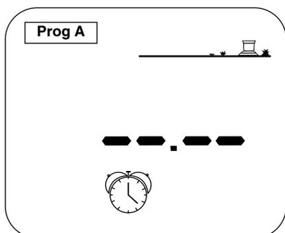
Sie können einen Beregnungszyklus bis zu 8 mal pro Tag starten. Zu jeder Startzeit führen alle Stationen eines Programms die Beregnung in der programmierten Dauer aus. Siehe Kap. IV. Geben Sie nun die Startzeiten für jedes Programm ein.
