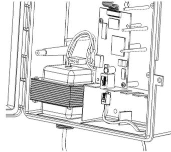
5 - Schließen Sie die Transformerkabel an das Mother Board an, wie in Diagramm 5 gezeigt.
