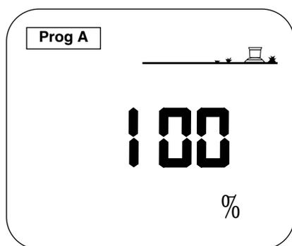
Mit der Funktion Wasserbudget kann die Berechnungsdauer für jedes Programm von 0 bis 200 % variiert werden, ohne die Berechnungsdauer für jede Station zu verändern.
