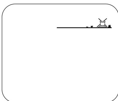
Um die Beregnung abzustellen, drücken Sie die Taste -/OFF und nun blinkt das Kreuz nicht mehr. Wenn Sie mit der Taste  $\rightarrow$  durch das Menü gehen, sehen Sie, dass das nicht blinkende Kreuz auf allen Anzeigen erscheint, außer auf dieser. Es wird keine Beregnung ausgeführt, weder manuell, noch automatisch. Um die Beregnung wieder zu gestatten, drücken Sie die Taste  $\rightarrow$ , bis die Anzeige mit dem blinkenden Kreuz erscheint. Dann drücken Sie die Taste +/ON. Das Kreuz ist weg.
