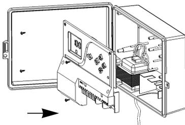
4 - Setzen Sie die Frontplatte wieder ein und schrauben sie fest.
