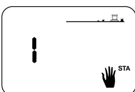
Die Station wird oben links angezeigt (Beispiel Station 1). Mit der Taste mit dem runden Pfeil kommen Sie auf die gewünschte Station. Um nun auf Station 1 einen Start manuell zu starten, drücken Sie die Taste **+/ON**. Die nun laufende Beregnung wird durch den blinkenden Wasserstrahl angezeigt.
