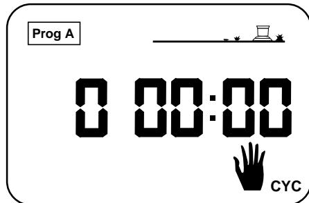
Wählen Sie mit der Taste **A/B** das gewünschte Programm, in dem Sie den Zyklus starten möchten. Oben links wird angezeigt, welches Programm Sie gewählt haben. Um den Zyklus zu starten, drücken Sie die Taste **+/ON** und der blinkende Wasserstrahl ist auf der Anzeige zu sehen. Station 1 wird angezeigt und die Berechnungsdauer wird abgezählt, danach kommt Station 2 usw. bis zur letzten Station, für die eine Berechnungsdauer eingegeben wurde.
