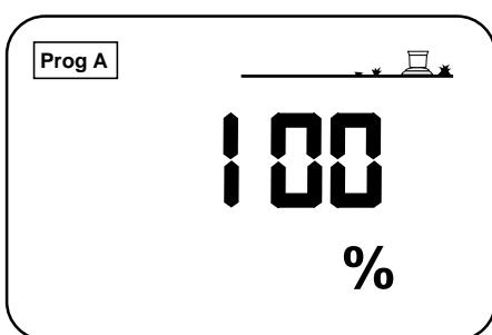
Wählen Sie zuerst das Programm **A/B** aus, in dem Sie die Beregnungsduer modifizieren möchten; oben links wird es angezeigt. Die Einstellung des Wasserbudget erfolgt mit den Tasten **+/ON** und **-/OFF** in Schritten von 10%. Die Anzeige zeigt die % an. 100% ist die Ausgangszahl und erscheint auf der Anzeige. Mit der Taste **+/ON** erhöhen Sie die Beregnungsduer, mit **-/OFF** können Sie sie vermindern.
