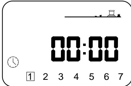
Die zwei blinkenden Punkte in der Mitte bedeuten, daß die Uhrzeit gerade angezeigt wird.
